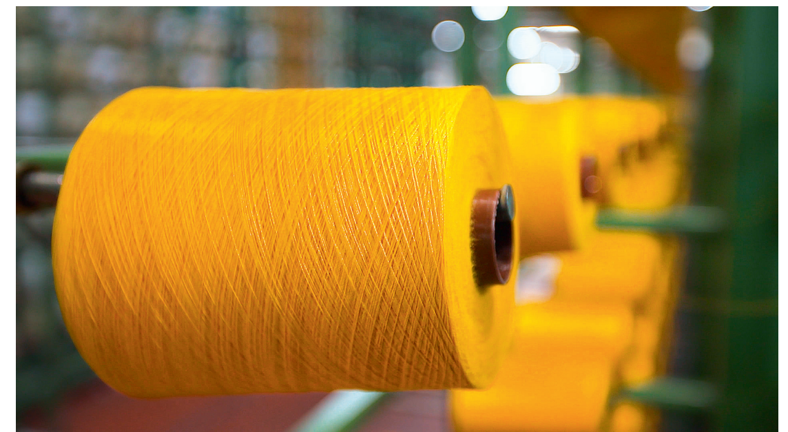
Door-en-door gekleurd garen gemaakt van gerecyclede PET-flessen.
