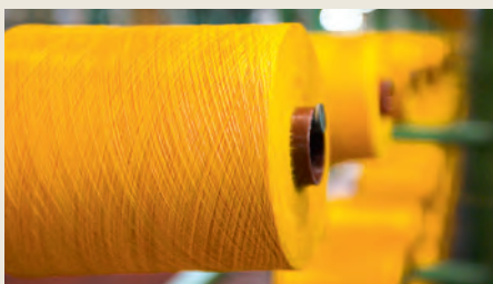
Il filo viene avvolto su bobine
